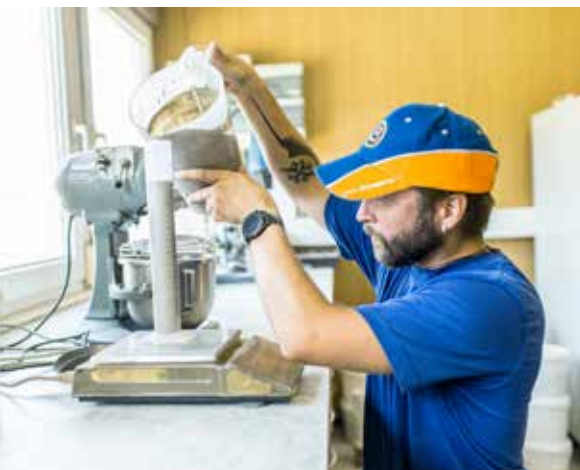
Bestimmung der Rohdichte
