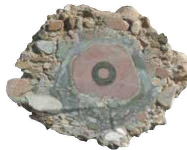
Querschnitt, verpresster selbstbohrender Kleinbohrpfahl, System Ischebeck (Quelle: Friedr. Ischebeck GmbH)
