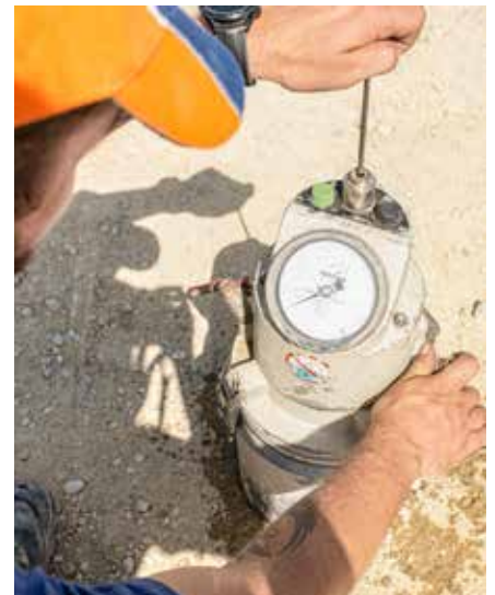
Bestimmung des Luftporengehalts von Frischbeton
